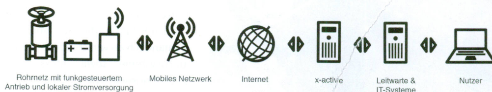
Schematische Darstellung der Kommunikation zwischen Leitstand und Armatur über Mobilfunknetz.
